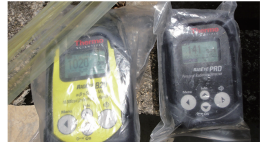
上・下左 表面汚染計測器 下右：シンチレーション式 サーベーター
