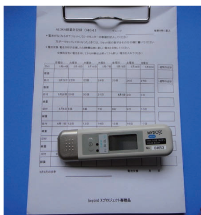
上：外部被曝線量測定“クイクセルパッチ”、これで個人線量を測定 下：累積線量を測定するポケット線量計と記録用紙。これで小舎毎の測定
