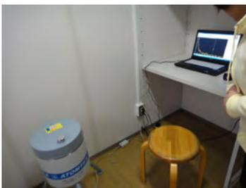
青葉学園の食品放射能測定器：ATOMTEX 食品放射能（セシウム）スクリーニングシステム
