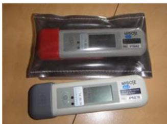
新しいモデルのポケット線量計 ALOKA PDM122B-SHC
